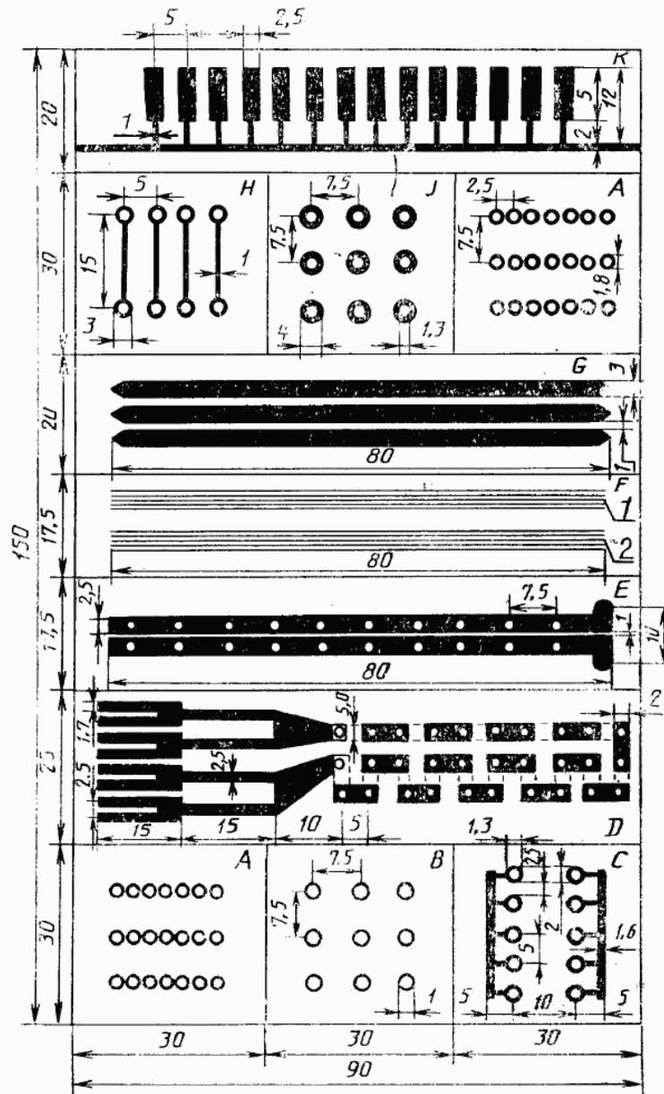
1 — ширина проводника и расстояние между проводниками 0,25 мм; 2 — ширина проводника и расстояние между проводниками 0,5 мм
